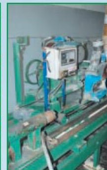
Drechselfräse für Rundholz-Blockbalken.
