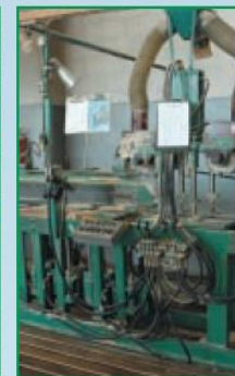
'Ritsu'-Aggregat für Verkämmungen und Bohrungen.
